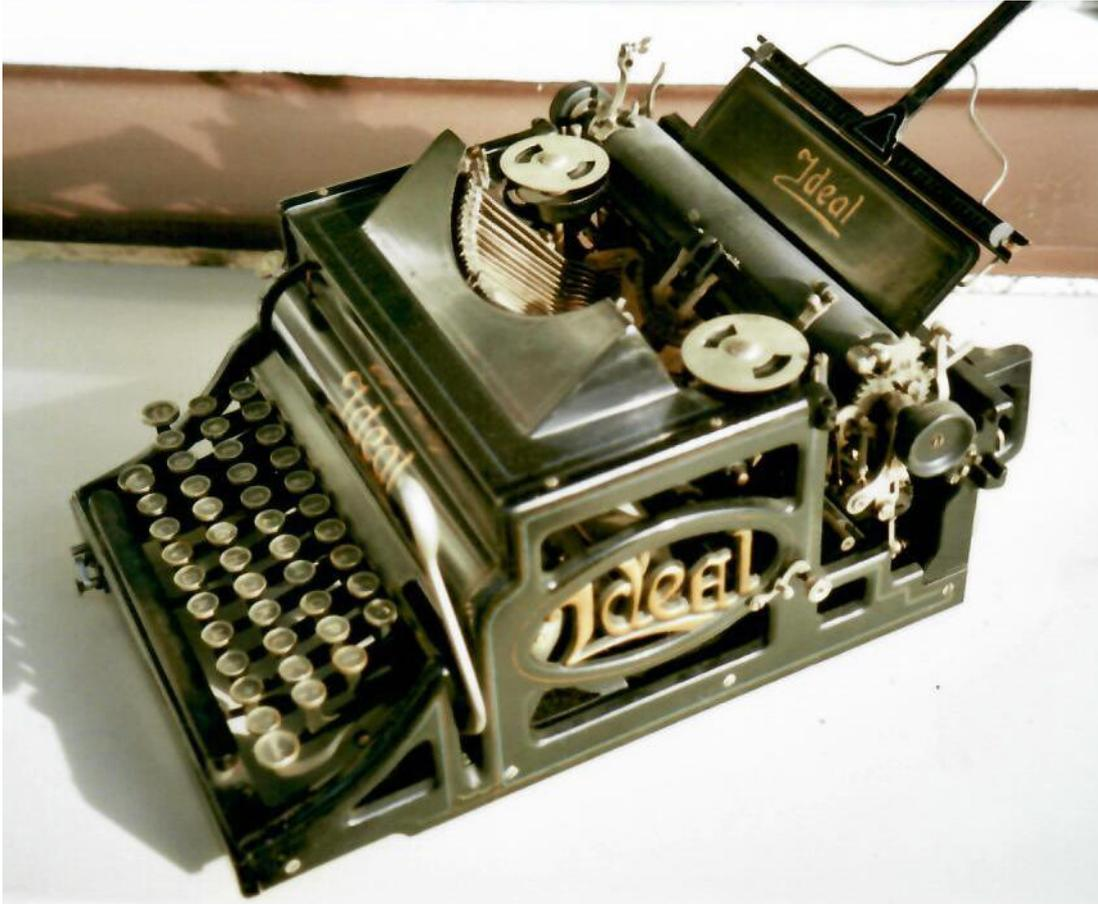
Unverkennbar ist hier die Nähe der früheren Nähmaschinengestelle. Und richtig, die „Ideal“ wurde produziert in der deutschen Fahrräder- und Nähmaschinenfabrik „Seidel & Naumann“ in Dresden, und zwar ab 1900. Sie ist die erste deutsche Maschine mit beim Schreiben sofort sichtbarer Schrift und fand deshalb einen großen Käuferkreis.
