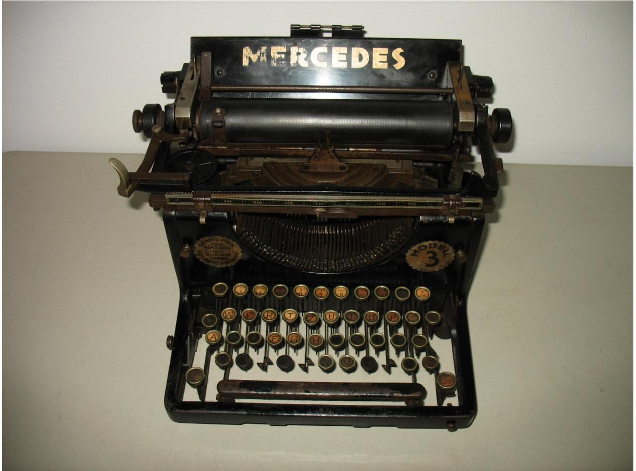
Die seit 1907 von der „Mercedes Bureaumaschinen GmbH“ produzierte Maschine verfügt über ein sofort lesbares Schriftbild, also Typenhebel mit Vorderaufschlag. Die Firma siedelte 1908 nach Zella-Mehlis in Thüringen um und firmierte unter „Mercedes Büromaschinen-Werke A.G.“
